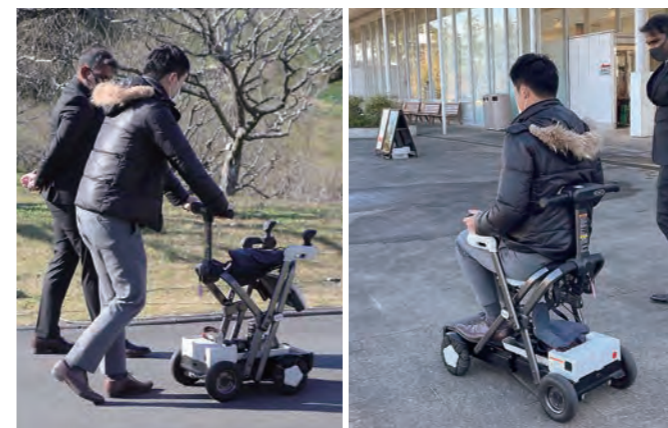
電動歩行補助具として、また、電動車いすとして使えます。
