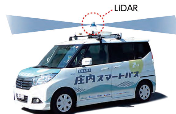
図3 屋根にLiDARを搭載した2号車
