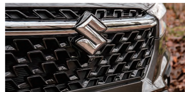
図12 SX4 Sクロスの外装フロントグリル(Sマーク下側のピアノブラック色の部品)
