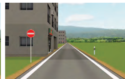
図6 進入禁止標識に対する標識認識機能の動作確認画面
