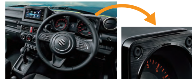
図8 ジムニー/ジムニーシエラのメータークラスター(右図の部品)
