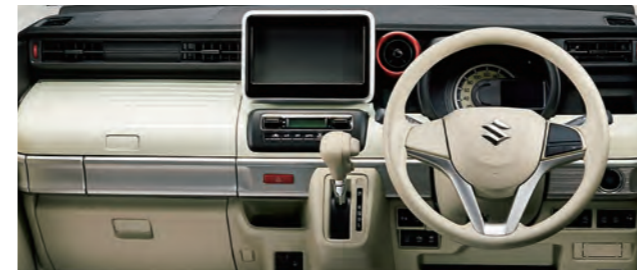
図7 スペースシアの内装インパネガーニッシュ(インパネ中段のアイボリー色の部品)
