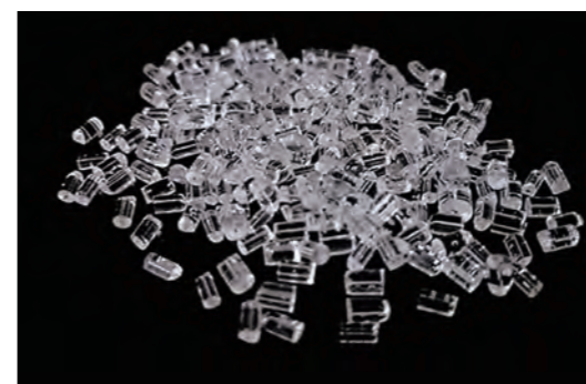
図1 バイオPCデュラビオ ® の材料写真 (引用:三菱ケミカルHP)
