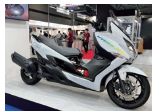
70MPaの水素タンクと水素エンジンを搭載した「バーグマン 400 ABS」
