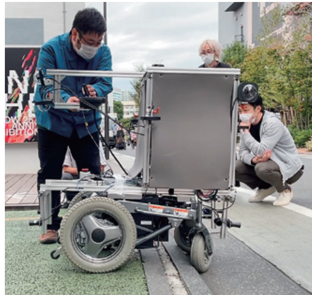
試作機を用いた段差乗り越えのテスト
