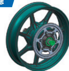
Vストローム800 リヤホイール CADデータ
